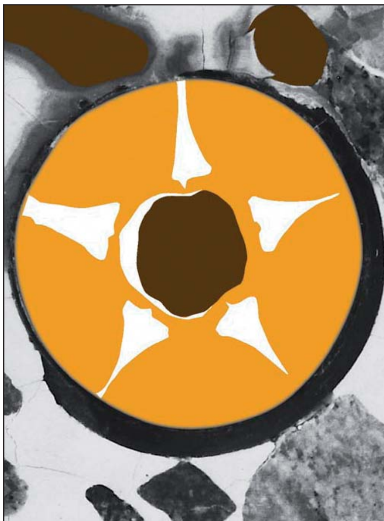
На фотографии среза тестового образца видна работа инъекционного шланга. Светло-серая масса – это микроцемент для первичной инъекции, коричневая масса – эпоксид, используемый при вторичной инъекции.
