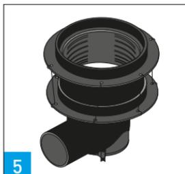
**FI:** Katkaise korokerengas haluttuun mittaan. Sahaa suoraan. Paina valkoinen tukirengas pohjaan asti. Tarkista, että kaivon tiiviste on puhdas ja paikoillaan. Paina korokerengas kaivon kaltevassa asennossa. Liukuaine helpottaa asennusta. Jos kaivo ja korokerengas valetaan betoniin samanaikaisesti, sido ne yhteen tukilappojen reikiin kautta sidontalangalla. Aseta kaivon valusuoja korokerenkaaseen valun ajaksi.
