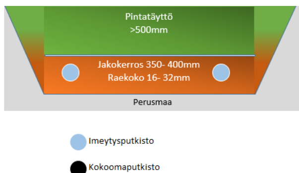
Erillisen imeytyskentän kerrokset
