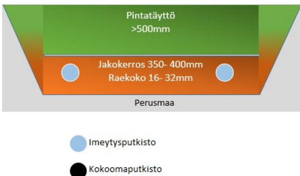
Erillisen imeytyskentän kerrokset
