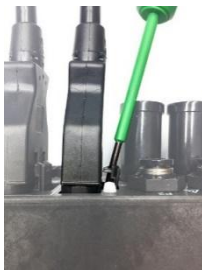
Kuva 13: 230 V:n pistokkeen kynnen löysäminen
