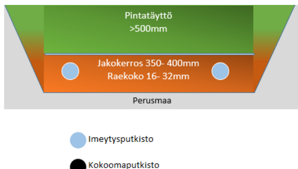
Erillisen imeytyskentän kerrokset
