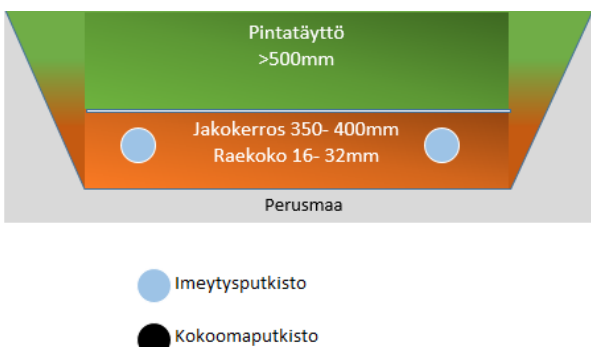
Erillisen imeytyskentän kerrokset
