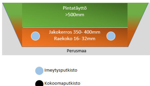
Erillisen imeytyskentän kerrokset
